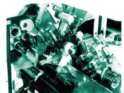
■ Greifeinrichtung und Hinterbohrereinrichtung
